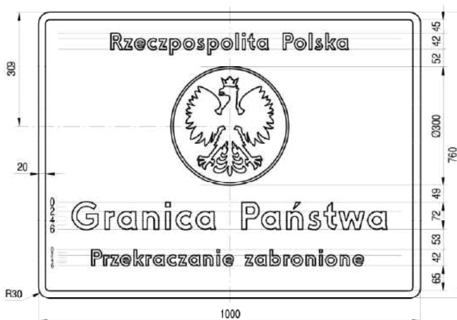
Rys. 9.6.2. Konstrukcja znaku F-2
