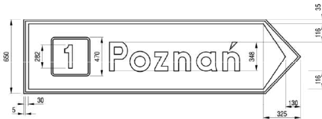
Rys. 9.5.24. Konstrukcja znaku E-3
