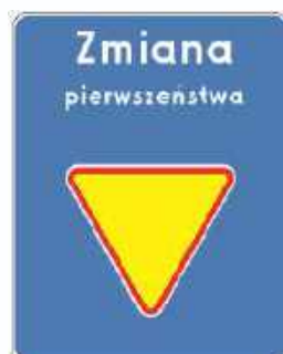
Rys. 5.2.54.2. Znak D-48 wskazujący wlot podporządkowany
