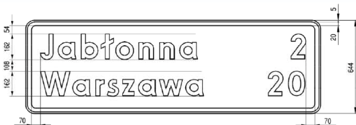
Rys. 9.5.43. Konstrukcja znaku E-13
