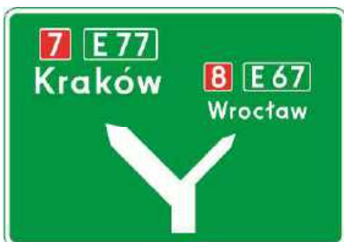
Rys. 6.3.1.2. Tablica E-1 przed trzypięciennym skrzyżowaniem dróg międzynarodowych
