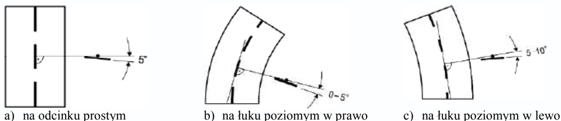
Rys. 1.5.5. Odchylenie poziome tarczy znaku:
