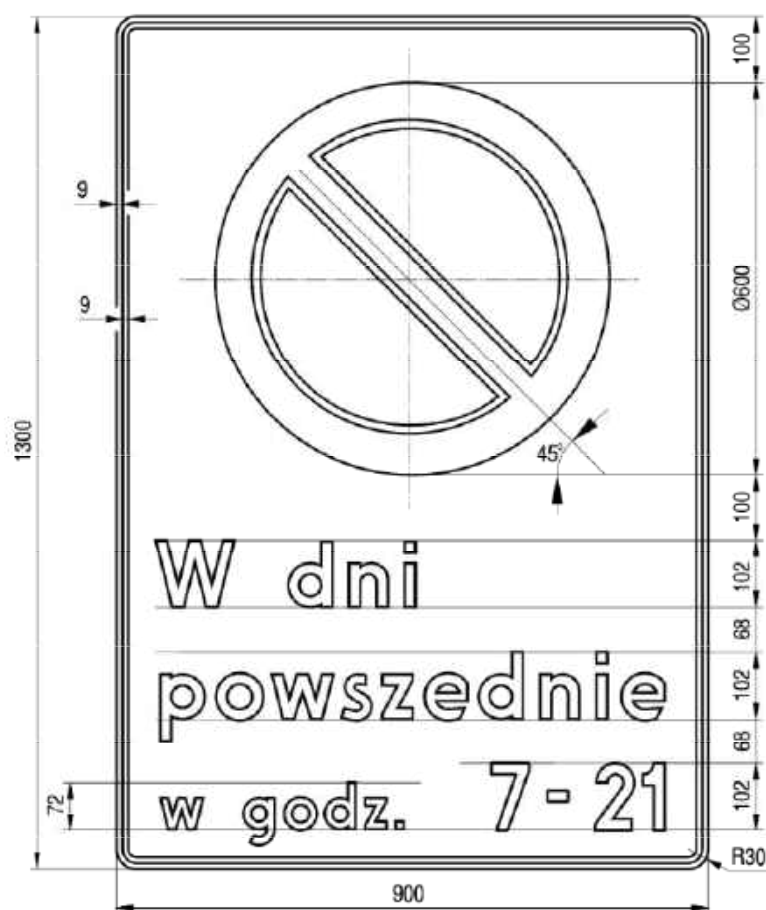
Rys. 9.2.47. Konstrukcja znaku B-39
