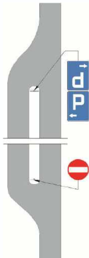
Rys. 3.2.2.5. Zastosowanie znaku B-2 w obiekcie przydrożnym
