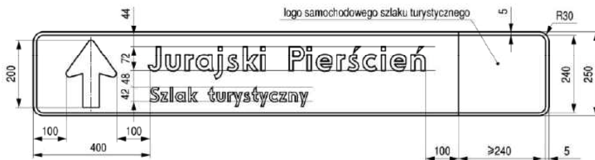
Rys. 9.5.54. Konstrukcja znaku E-22a
