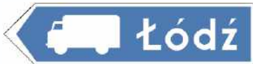
Rys. 7.2.13.2. Znak F-13 wskazujący przejazd tranzytowy do miejscowości
