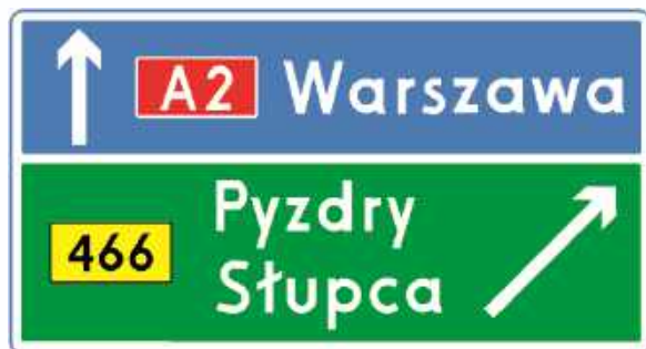
Rys. 6.3.2.5. Drogowskaz E-2c na autostradzie
