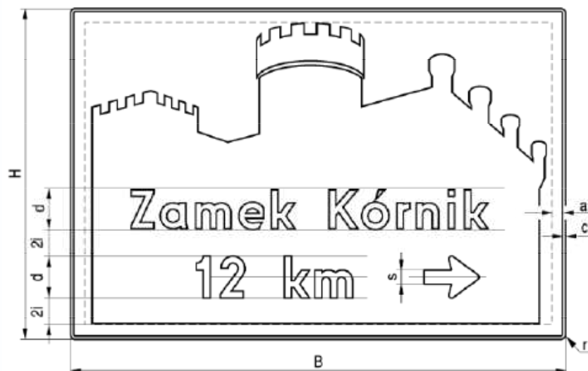
Rys. 9.5.56. Konstrukcja znaku E-22b
