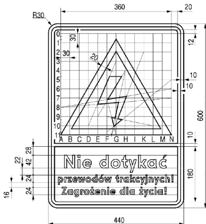
Rys. 9.8.7. Konstrukcja znaku G-2
