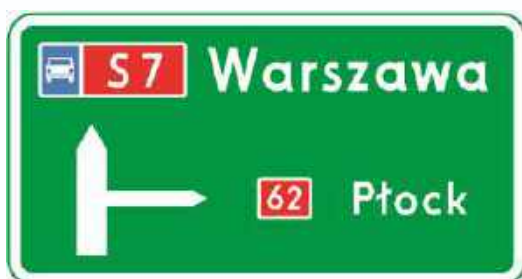
Rys. 6.3.1.7. Tablica E-1 na początku drogi ekspresowej
