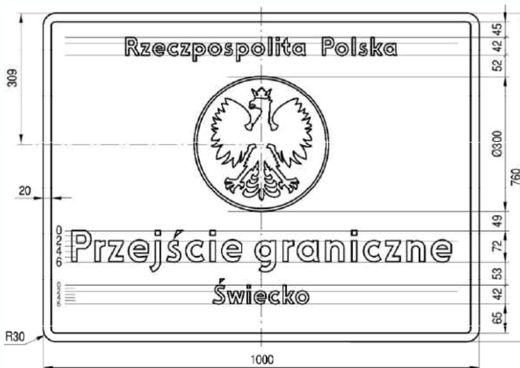
Rys. 9.6.1. Konstrukcja znaku F-1
